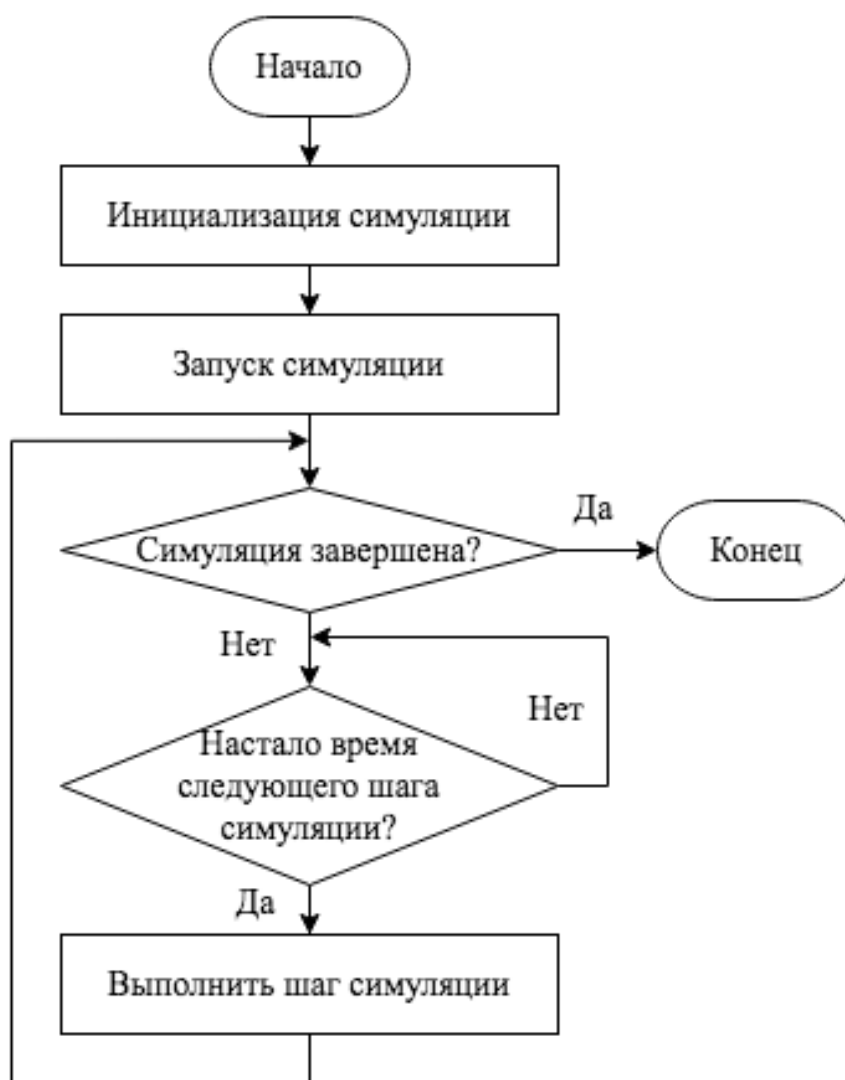
Рисунок 29. Базовый алгоритм работы симулятора.
